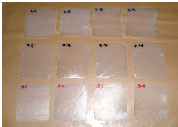
Gambar 3. Spesimen uji kopolimer blok polipropilena
